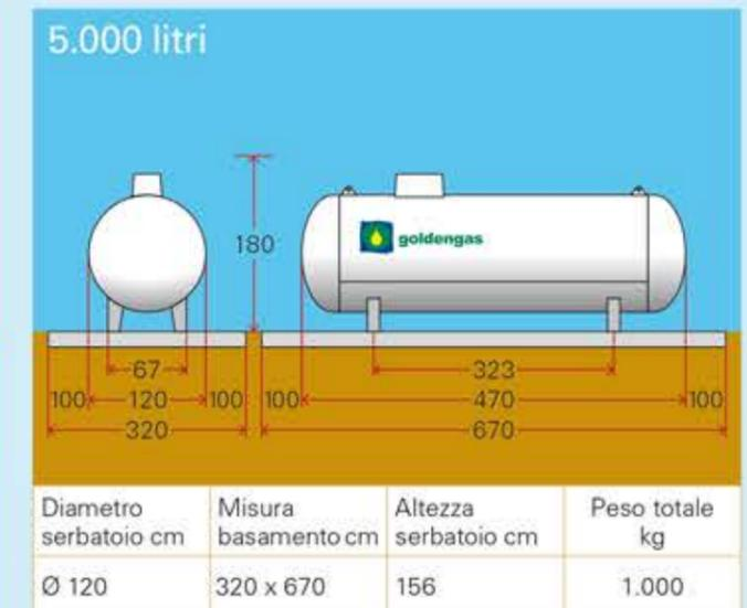
**NB.** Nella recinzione va apposta una porta di 90 cm apribile verso l'esterno. Nel caso in cui nel raggio di 5 m attorno al serbatoio vi sia vegetazione, occorre predisporre alla base della recinzione un muro di contenimento alto 50 cm.
